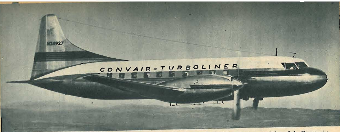
• Ecco il Convair sperimentale Turbo-Liner, provvisto di due turbopropulsori Allison T-38, di 2750 cav ciascuno. Esso è il primo aeroplano da trasporto americano azionato da motori di
