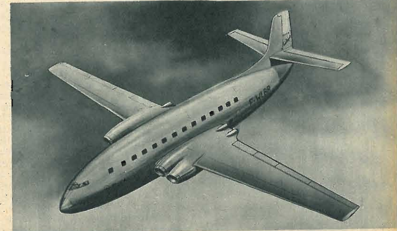
• Il Breguet Fulgur 97 (49 t, 100 passeggeri) è provvisto sia di quattro turboreattori Nene , sia di quattro turbopropulsori Armstrong o Allison.
