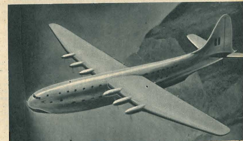
• L'idrovolante per lunghi percorsi Saunders-Roe Princess da 142 t con 10 turbopropulsori Proteus , raggiunge una velocità di oltre 600 km/h.
